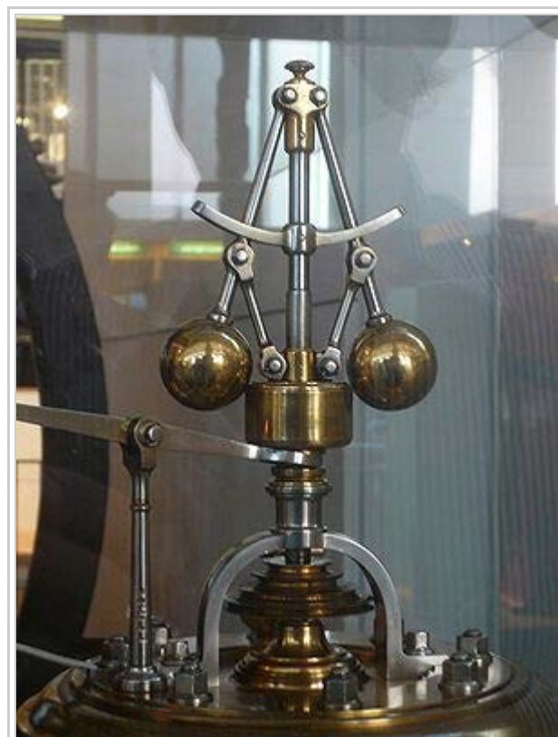
Fliehkraftregler einer Dampfmaschine
