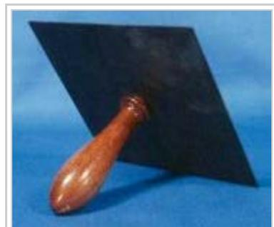
Eine quadratische sympathetische Chladnische Klangplatte mit Handgriff in der Ausführung von Rudolph Koenig aus dem St. Mary's College. Über einer gleichartigen schwingen Platte gehalten, übernimmt sie deren Schwingungsmode.
