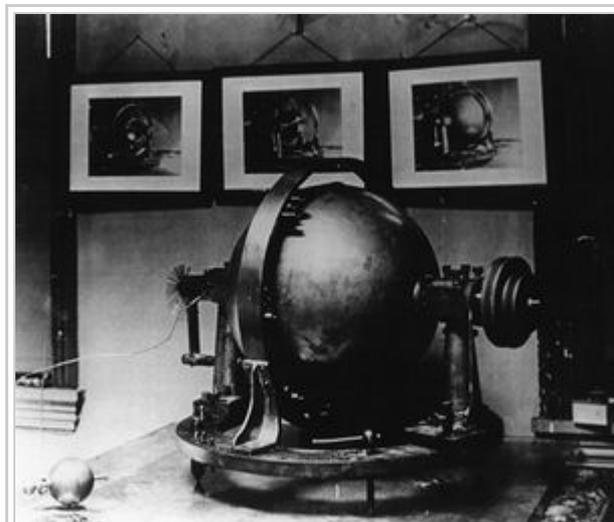
Dynasphäre aus den 1880iger Jahren; links vorne ein Liberator, der durch einen Draht mit der Maschine verbunden ist. Ganz links außen auf der Achse der Dynasphäre ist der auf die diatonische Skala gestimmte Resonator (*Diatonic Scale Resonator*) aus radial angeordneten Klangstäben zu sehen, der von Keely häufig für seine Apparaturen verwendet wurde.
