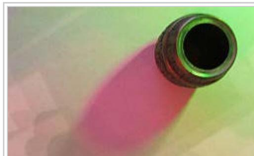
Mit grünem Licht erzeugter Schattenwurf (links) eines Gegenstandes, aufgehellt durch eine zweite Lichtquelle, vor die nun eine rote Folie gehalten wird. Es entsteht ein farbiger Schatten in der roten Gegenfarbe, der durch die rote Folie noch intensiver hervortritt. Der Schatten der roten Folie wird durch die erste Lichtquelle grün eingefärbt und ist gut zu erkennen.
