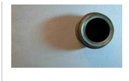
Mit blauem Licht erzeugter Schattenwurf, aufgehellt durch diffuses weißes Tageslicht. Es entsteht ein orange-bräunlicher farbiger Schatten, durchschnittlich RGB(138,106,83). Ein klares Orange vergleichbarer Helligkeit läge bei etwa RGB (250,106,0). Die Blaufärbung des weißen Untergrunds schwankt um RGB (151-177,188-213,206-227).
