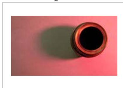
Mit rotem Licht erzeugter Schattenwurf, aufgehellt durch diffuses weißes Tageslicht. Es entsteht ein grünlicher farbiger Schatten, durchschnittlich RGB(86,81,61). Ein deutlicheres Grün vergleichbarer Helligkeit läge bei etwa RGB (61,81,61). Die Rotfärbung des weißen Untergrunds schwankt um RGB (253-255,100-133,118-140).
