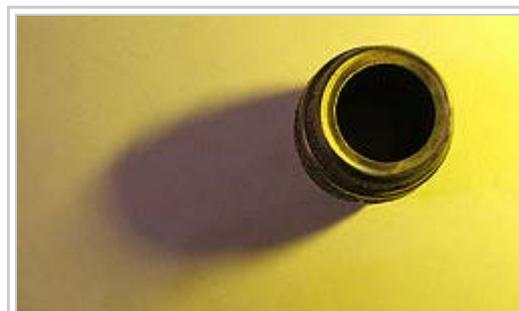
Mit gelbem Licht erzeugter Schattenwurf (links) eines Gegenstandes, aufgehellte durch eine zweite, weiße Lichtquelle. Es entsteht ein farbiger Schatten in der violetten Gegenfarbe. Der durch das weiße Licht geworfene Schatten (rechts) wird durch die gelbe Lampe gelb eingefärbt, ist aber in dem gelb beleuchteten weißen Untergrund kaum zu erkennen.
