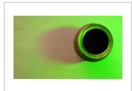
Mit grünem Licht erzeugter Schattenwurf, aufgehellt durch diffuses weißes Tageslicht. Es entsteht ein rötlich erscheinender farbiger Schatten mit einem durchschnittlichen RGB-Wert (161,130,99).
