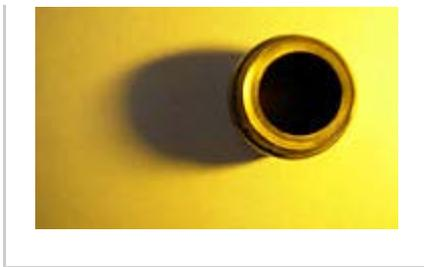
Mit gelbem Licht erzeugter Schattenwurf, aufgehellt durch diffuses weißes Tageslicht. Es entsteht ein farbiger Schatten in gräulicher, schwach violettstichiger Farbe, durchschnittlich RGB(70,61,52). Ein klares Violett vergleichbarer Helligkeit läge bei etwa RGB (70,0-35,70). Die Gelbfärbung des weißen Untergrunds schwankt um RGB (250-253,240-253,63-102).
