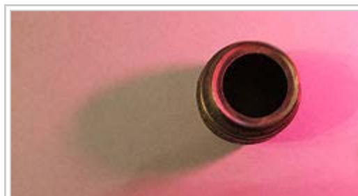
Mit rotem Licht erzeugter Schattenwurf eines Gegenstandes, aufgehellt durch eine zweite, weiße Lichtquelle. Es entsteht ein farbiger Schatten in der grünen Gegenfarbe. Der durch die weiße Lichtquelle geworfene Schatten (rechts) wird durch das rote Licht deutlich intensiver eingefärbt als der weiße Untergrund. Man kann also unterscheiden zwischen dem *farbigen Schatten* links und dem *gefärbten Schatten* rechts.
