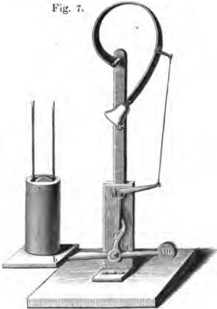
zur Erde ablaufende Treibgewicht setzt auf das Brettchen  $b$  auf, wodurch  $c$  unter  $d$  weggezogen und die Klingel durch freies Schwingen der Feder zum Tönen gebracht wird. Sobald beim Aufziehen des Apparates  $b$  frei wird, fällt das schwere Gegengewicht  $m$  zurück, zieht  $c$  unter  $d$  weg und der Apparat ist von selbst zu neuer Wirksamkeit bereit.
