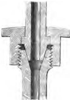
zu sehen. In der wirklichen Grösse kann die innere Weite der Röhren doppelt so stark, die massiven Theile aber in gleicher Wandstärke wie in der beistehenden Figur genommen werden. Diese Verbindung ist sehr dicht, augenblicklich angesetzt und gelöst, und immer zum Gebrauch bereit. Die Schliessvorrichtung ist aus Messing und an die Bleiröhre mit Zinnloth angelöthet. Bleierne Röhren mit einem äusseren Durchmesser von 6 Linien sind am passendsten <sup>1)</sup>.
