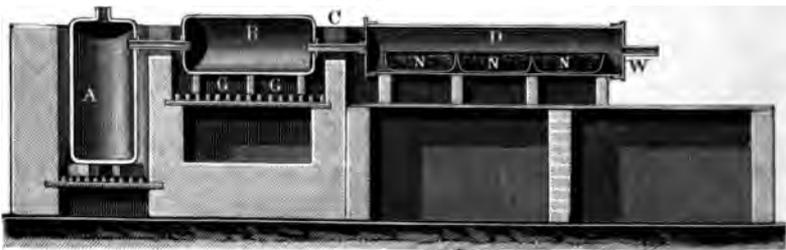
80 Kilogramm. Eisenspitzen (*Pointes de fer*) gefüllt ist und durch einen besonderen Heerd *G* bis zur dunkeln Rothgluth erwärmt werden kann. Dieser zweite Cylinder *B* dient zum Reinigen des rohen Aluminiumchlorids, indem das metallische Eisen das leicht flüchtige Eisenchlorid in schwerer flüchtiges Eisenchlorür verwandelt, die durch das Einwirken der atmo-
