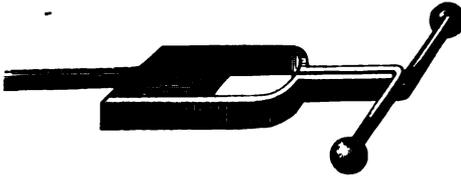
platte angeschraubten Backen sind auf der Schlussfläche halbrund gefeilt, um das Kautschukrohr nur in einer Linie zusammenzupressen. Der stiel förmige Theil wird in eine, an einem Stativ auf und ab bewegliche Hülse eingeschoben. Mohr
