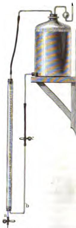
Kugelröhre, an welche die Fresenius'schen Röhren angebracht werden, gestattet beim Ausfliessen den Lufteintritt.
