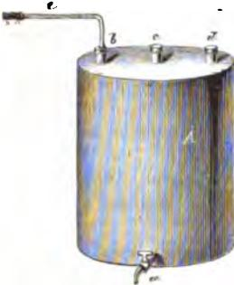
Substanzen, welche das Wasser mit äußerster Hartnäckigkeit zurückhalten, trocknet man im luftleeren Raume, unterstützt durch eine steigende Temperatur. Fig. 51 zeigt diese Einrichtung. *e* ist eine kleine Handluft-
