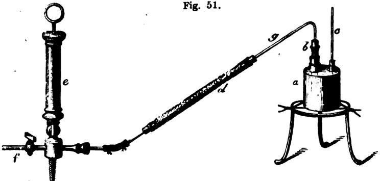
pumpe, *d* ein Chlorcalciumrohr, welches durch die Röhre *g* mit einer cylindrischen, starken Röhre *b* in Verbindung steht. Letztere, welche
