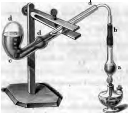
chen anfangs gelinde, allmählig aber stärker, lässt, wenn die Chlorentwicklung beendigt ist, die sich mit Knattern verdichtenden Wasserdämpfe den Apparat noch einige Minuten durchströmen und streift dann, ohne die Lampe zu entfernen, das Kautschukrohr *b* rasch von dem Kölbchen ab. Der Inhalt der Retorte wird in ein geräumiges Becherglas entleert und Retorte und Gasleitungsröhre mit destillirtem Wasser sorgfältig nachgespült. Wesentlich ist bei dieser Destillation, dass der luftegefüllte Raum
