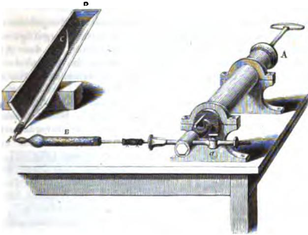
Die Verbrennungsröhre und Chlorcalciumröhre müssen genau horizontal oder etwas gegen
