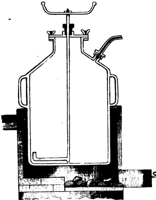
einen Windofen passenden gusseisernen Gefässes betrage 18 Zoll, der horizontale Durchmesser 11 Zoll, die Weite der Oeffnung 4 bis 5 Zoll. Eine engere Einfüllöffnung wird leichter schliessend gemacht werden können, so weit soll sie aber immer bleiben, dass man behufs des Entleerens und Ausräumens mit dem Arm hineinfahren kann. Die Oeffnung hat einen hervorragenden Rand oder Flantsche zur besseren Befestigung des Deckels, die Wände zwischen Hals und dem cylindrischen Bauch des Gefässes bil-
