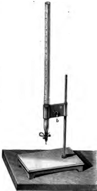
Volumen der Maassflüssigkeit erfordert wird, dienen solche von 100 CC. oder 60 CC. in  $\frac{1}{5}$  CC. getheilt, zu feineren Versuchen 25 CC., bis 10 CC. fassende, die in  $\frac{1}{10}$  CC. oder noch kleinere Volume getheilt sind.
