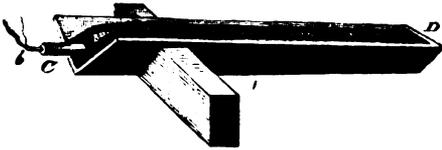
horizontal oder etwas gegen den Kaliapparat geneigt gelegt werden, damit das in dem engen Theile der letzteren sich sammelnde Wasser von selbst hineinfließt; man legt zu diesem Zweck
