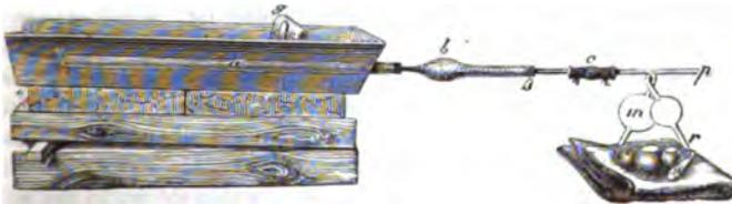
ler Vorrichtung. *a* ist die Verbrennungsröhre, *b* die Chlorcalciumröhre, welche durch ein Kautschukröhrchen mit *m*, der grösseren Kugel des Kaliapparates, in Verbindung steht, *e* ist ein Ziegelstein. *f* ein darunter geschobenes Stück Eisen, um dem Ofen eine nach dem Kaliapparate geneigte Lage zu geben.
