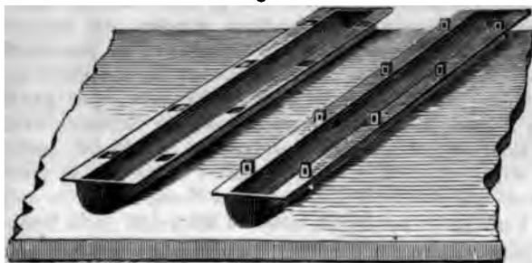
besteht aus zwei genau auf einander passenden Theilen, welche zusammengelegt einen hohlen cylindrischen Raum von 1 Fuss Länge und 2 Zoll Durchmesser umschliessen. Fig. 82 stellt die geschlossene Form
